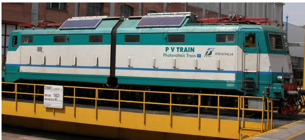
Applicazione dei moduli fotovoltaici US 116 sul locomotore elettrico E 636
